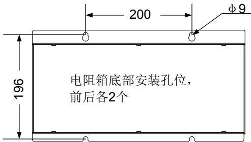
图 3-12 制动电阻箱底部安装孔位置及尺寸图（单位：mm）
